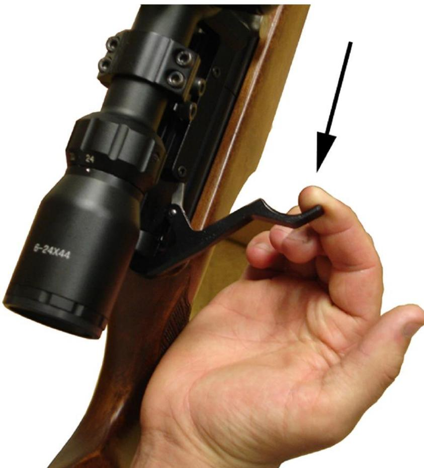
Wenn Sie feststellen, dass das System nicht vollständig gespannt ist, aber das Magazin verschoben wurde, spannen Sie das Gewehr erneut. Bevor Sie jedoch den Hebel zurückführen, nehmen Sie das Magazin heraus und schieben es manuell auf die leere Kammer zurück. Setzen Sie das Magazin wieder ein und schießen Sie. Wird dieser Vorgang nicht befolgt, ist es wahrscheinlich, dass Sie eine zweite Kugel in den Lauf laden.
